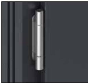
Závěs Premium Simonswerk řady 4000 regulace 3D nosnost 160 kg. vyztužený proti vylomení záruka 30 let (200 tisíc cyklů)
